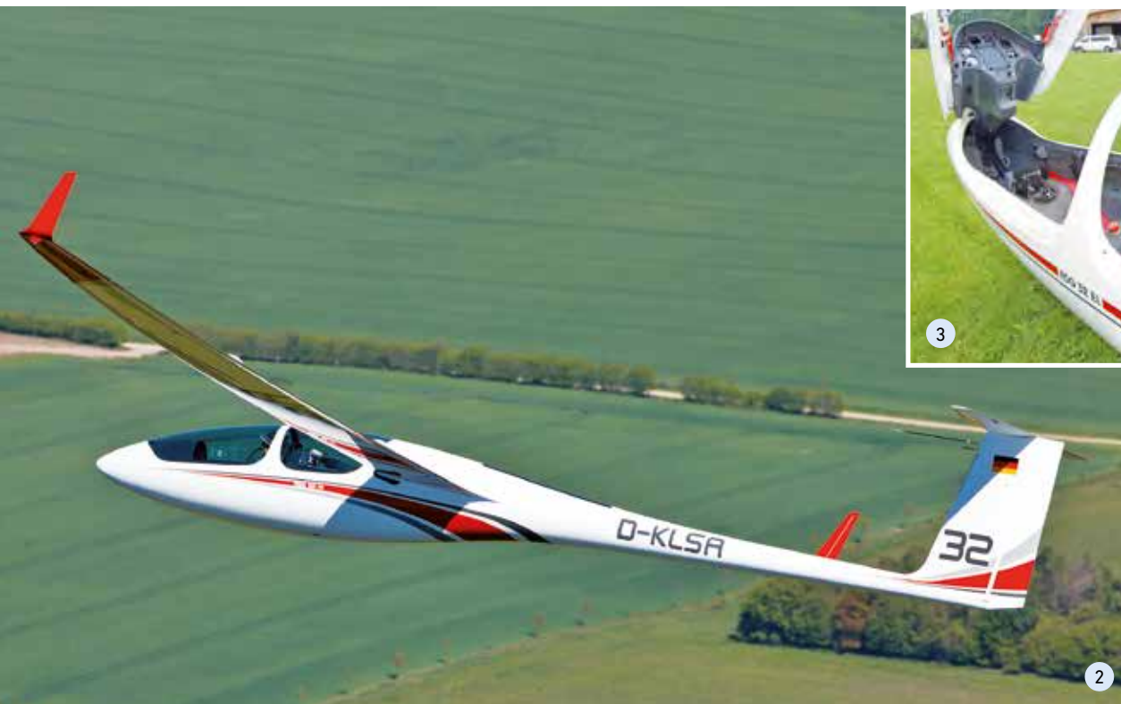
2: Die verwendeten Verbundwerkstoffe sind temperaturunempfindlicher und erlauben sicherheitsrelevante Dekors
