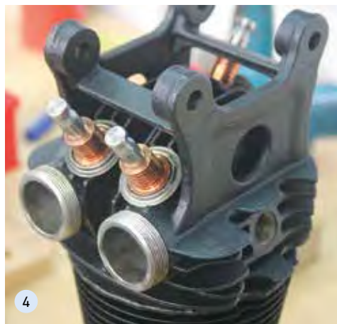
3: Motorblock des von Ferdinand Porsche für Hans Klemm konstruierten Daimler F 7502 4: Einer der beiden Zylinder des Boxermotors. Beide haben einen Hubraum von 884 ccm
