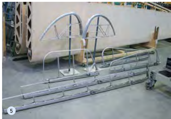
und verhelfen dem Leichtflieger zu 16 kW Leistung 5: Nachgefertigte Leichtmetallteile für Ruder und Randbögen
