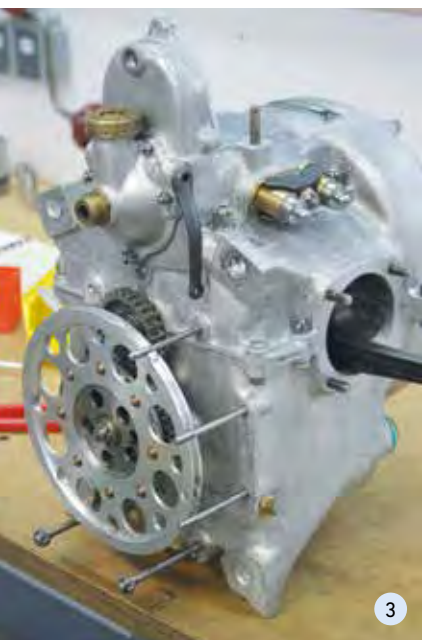
3: Motorblock des von Ferdinand Porsche für Hans Klemm konstruierten Daimler F 7502 4: Einer der beiden Zylinder des Boxermotors. Beide haben einen Hubraum von 884 ccm
