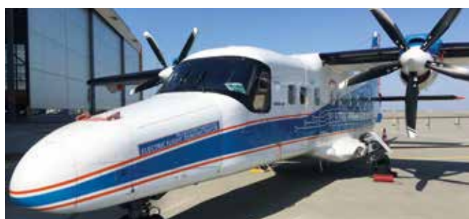
Die Do 228 wird von der DLR auf 500 kW starke E-Motoren umgebaut
