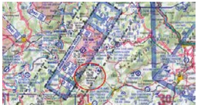
Der Flughafen Hahn EDFH ist einer von elf Flughäfen mit TMZ, rot markiert die vertikale Ausdehnung, der Transpondercode und Monitorfrequenz
