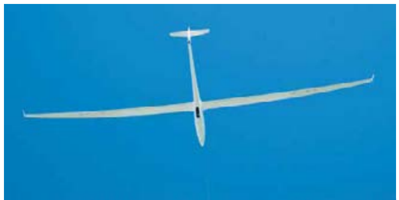
Das experimentelle Segelflugzeug Nixus verfügt über elektrisch betätigte Querruder und Wölbklappen.
