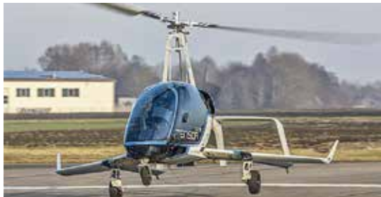
Der Fraundorfer Tensor 600X ist ein Tragschrauber mit Flügeln für zusätzlichen Auftrieb
