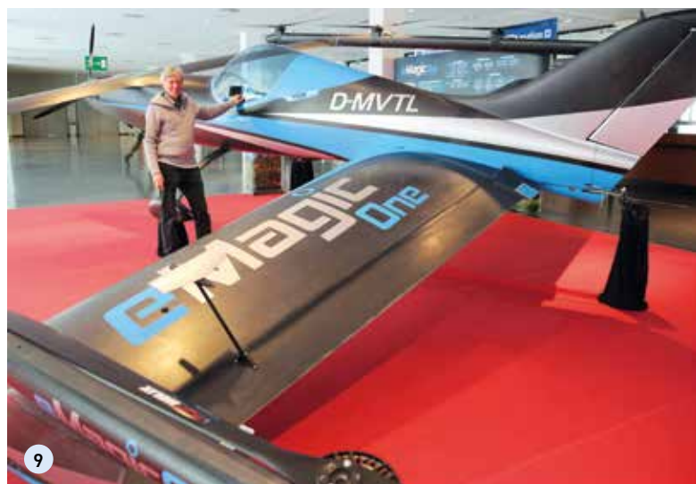
9: Die voll in CFK gebaute eMagic one von Michael Kügelgen kann senkrecht starten und landen. Futuristisch, aber keine Vision mehr, denn sie fliegt schon seit dem Frühjahr 2021.
