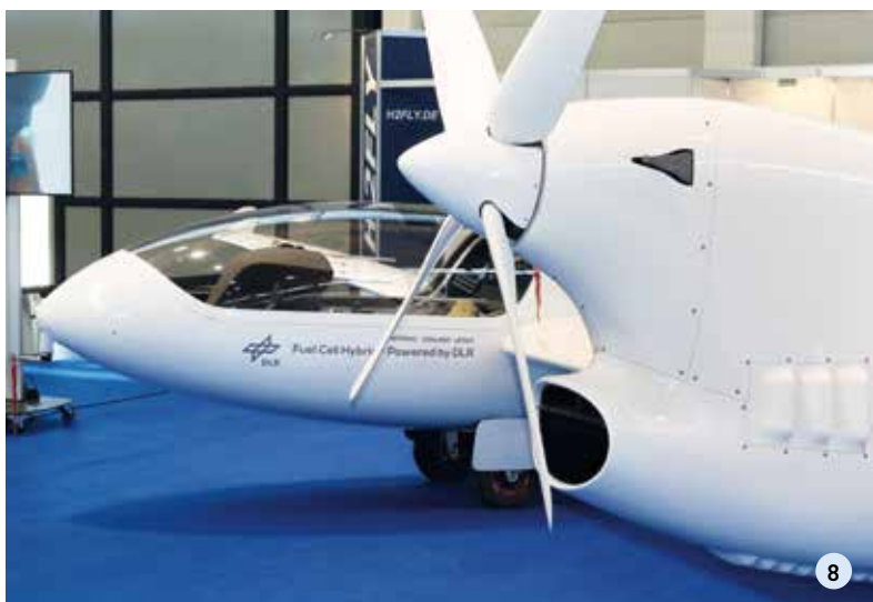
8: Der Erprobungsträger für Flugzeugantriebe mit Wasserstoff „H4FLY“ ist nahe an dem, was derzeit in dieser Zukunftstechnologie möglich ist
