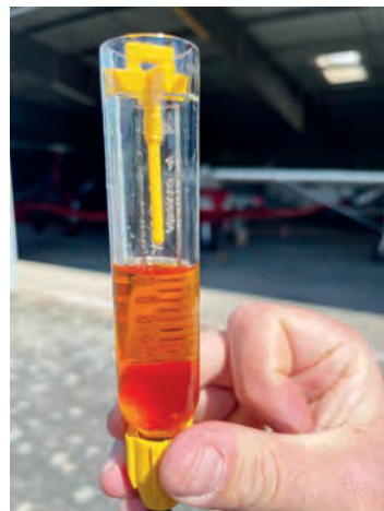
▲ Foto 1: Ups! Vorsichtshalber gedraint, obgleich das Flugzeug eben geflogen ist – nach 5 Monaten Standzeit
