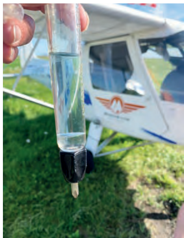
◀ Foto 3: Wasser im AVGAS in Klaipeda bei der Vorflugkontrolle
