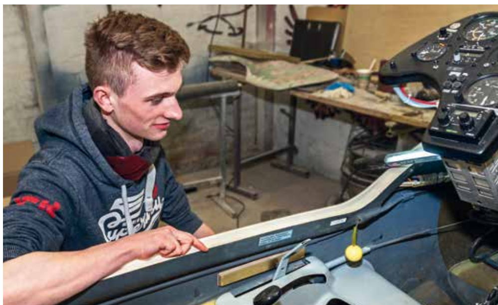
Mathias Henckels sieht sich den Hebel an, mit dem er künftig anstelle mit den Füßen das Seitenruder des Flugzeuges mit der Hand bedienen kann. Die Firma Aeroconcept GmbH Merzbrück rüstet das Flugzeug fachgerecht mit der zusätzlichen Handsteuerung aus.
